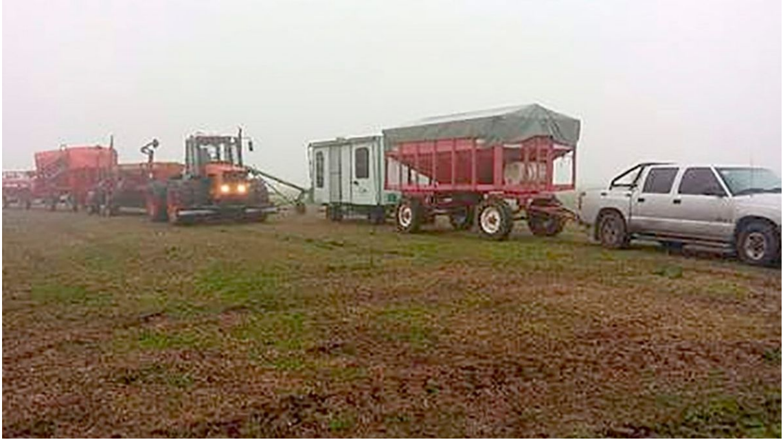
Imagen 13. Equipo de Siembra y Fertilización. De derecha a izquierda: Camioneta, Tolva la semilla, Casilla, Chimango, Tractor, Sembradora, Tolva para fertilizantes, Tanque de combustible.
