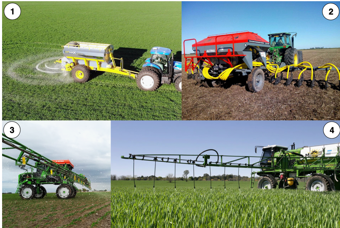
Imagen 6. Distintos formas de llevar a cabo la fertilización de cultivos. 1) Fertilización al voleo, 2) Fertilización incorporada, 3) Fertilización neumática, 4) Fertilización líquida (chorreada).
