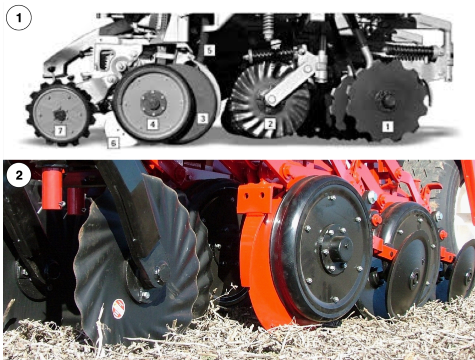
Imagen 3. Tren de Siembra de Sembradoras de Siembra directa. 1) Esquema conceptual del tren de Siembra (1. Doble disco fertilizador que localiza al fertilizante
